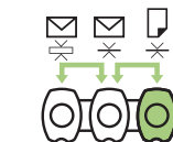
封筒ガイド 給紙圧調節レバー
