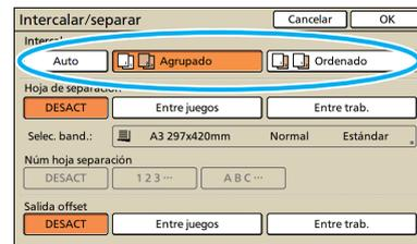
**!** Si se selecciona [Auto], [Ordenado] se ajusta automáticamente si se utiliza el alimentador automático de documentos y [Agrupado] se ajusta al utilizar el cristal.
