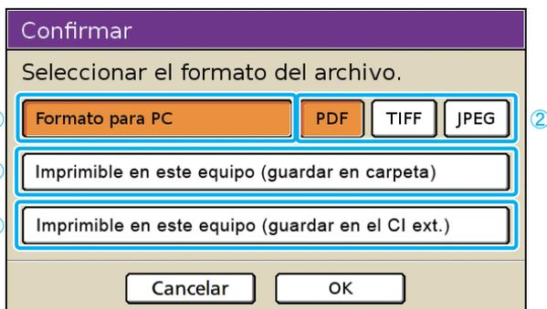
Si se selecciona el modo escáner, aparecerá una pantalla de confirmación para especificar el formato de escaneo. Después de seleccionar el formato, pulse [OK] para ir a la siguiente pantalla.
