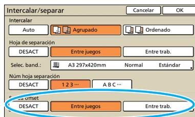
Estos botones no se muestran a menos que se conecte un finalizador multifunción opcional unidad salida Offset boca abajo, apilador de alta capacidad.
