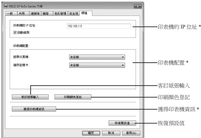
\* 在 USB 快閃磁碟機印表機驅動程式的 [印表機配置] 和 [獲得印表機資訊] 下，不會出現 [印表機的 IP 位址] 及 [儲存記憶卡]。
