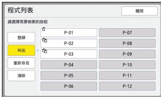
▶ 按鈕上的圖示顯示編程列表的類型。
