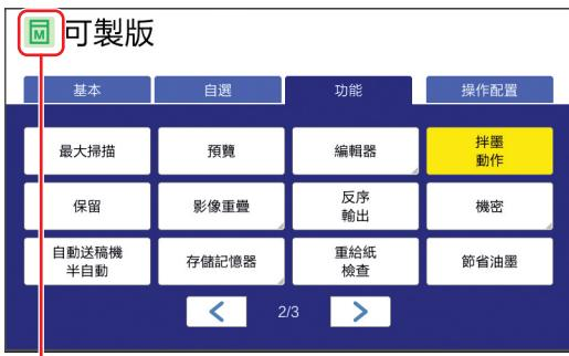
[拌墨動作] 開啟時，製版基本屏幕的訊息區域中顯示的圖示會變更。
