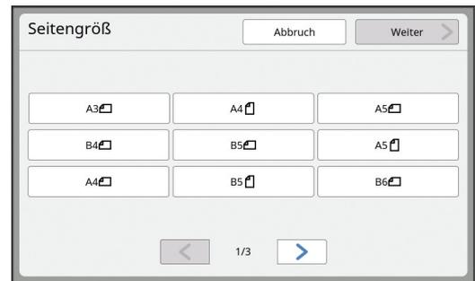
**!** **► Tippen Sie bei Vierfach- und Sechzehnfachdruck auf eine Originalgröße-Schaltfläche mit einem -Symbol.**
