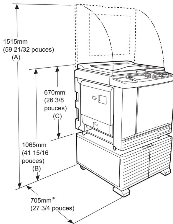
Quand l'alimentateur automatique de documents optionnel est installé, les valeurs de (A) à (C) de la figure ci-dessus sont les suivantes.
