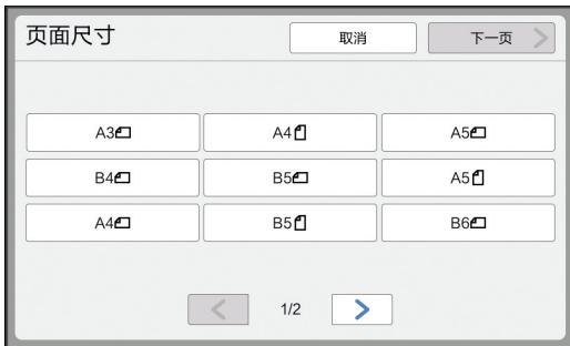
**!** ▶ 对于 4 面连写和 16 面连写印刷，触摸显示  符号的原稿尺寸按钮。
