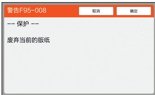
[确定]：触摸该按钮废弃已经制作的版纸。
