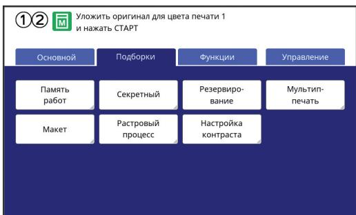
Можно зарегистрировать функции на экране вкладки [Подборки] для каждого из следующих режимов.
