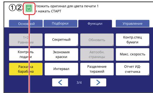
Если функция [Раскатка барабана] включена, значок в области сообщений основного экрана изготовления мастера изменится.
