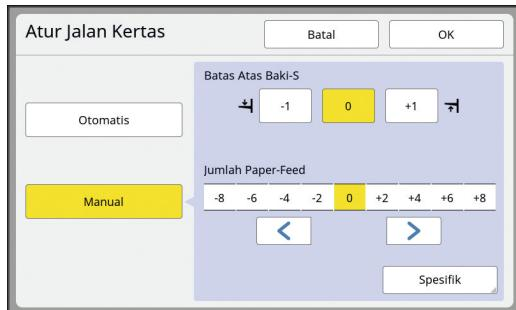
Sentuh [Spesifik] untuk menentukan [Clutch ON Timing] dan [Clutch OFF Timing].
