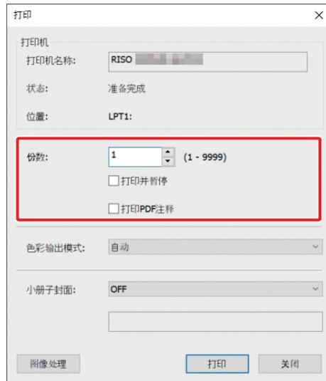
选择了[打印并暂停]复选框时，将打印（装订）一份，然后本机将停止。在确认装订状态后，可以打印（装订）所设置份数的剩余部分。
