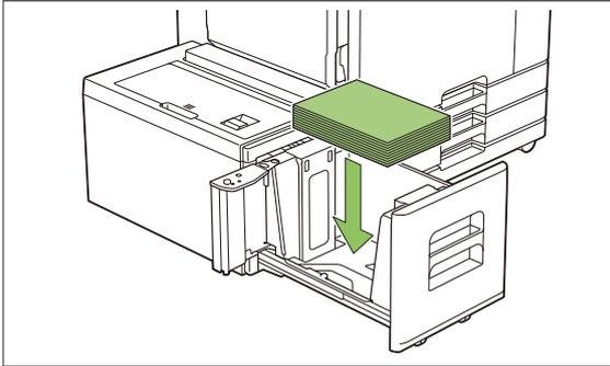
**4** Schieben Sie die Papierführung zurück, bis sie an der Außenkante des Papiers ausgerichtet ist.
