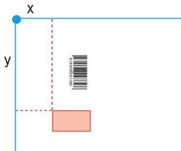
Beispiel für eine fehlerhafte Barcodeverarbeitung, da das Original gedreht wurde und sich die Position des Barcodes relativ zum Basispunkt geändert hat
