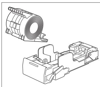
**2 Вытяните блок скрепок из картриджа лицевой стороной вверх, одновременно нажимая на рычаг на задней стороне картриджа в направлении стрелки.**
