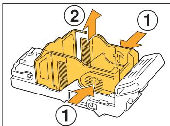
**4 Вставьте переднюю часть нового футляра со скрепками в картридж, затем вставьте заднюю часть.**
