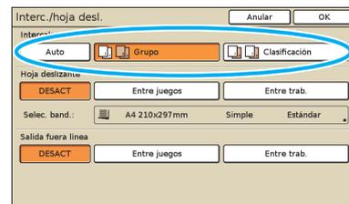
**!** Si se selecciona [Auto], [Clasificación] se ajusta automáticamente si se utiliza el alimentador de documentos automático y [Grupo] se ajusta al utilizar el cristal.
