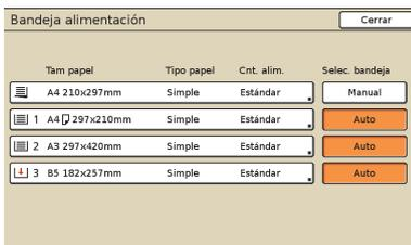
En la pantalla [Bandeja alimentación], realice los ajustes de papel detallados pulsando los botones de la bandeja.
