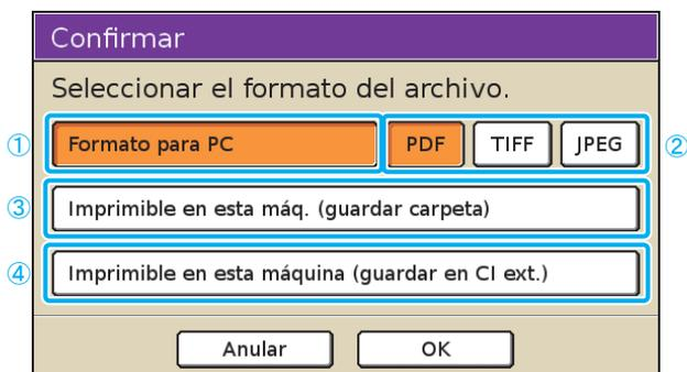
Si se selecciona el modo escáner, aparecerá una pantalla de confirmación para especificar el formato de escaneo. Después de seleccionar el formato, pulse [OK] para ir a la siguiente pantalla.
