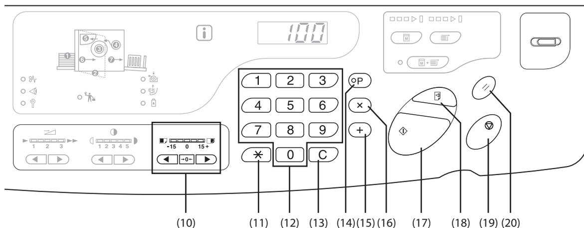
**(10) Teclas/Indicador de Ajuste da Posição de Impressão Vertical (☞p.76)**
